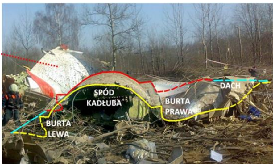
Rysunek 3. Tylną sekcję kadłuba znaleziono do góry dnem, obie strony wygięte na zewnątrz, z wyraźnymi oznakami wewnętrznego ciśnienia, gdy kadłub znajdował się w powietrzu.
