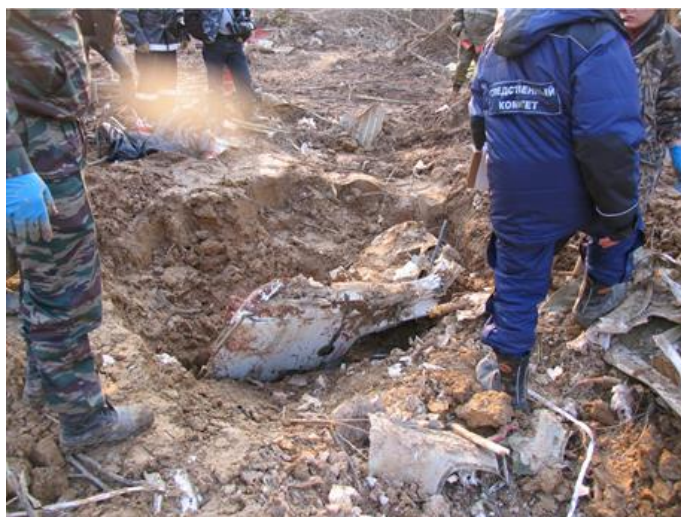
Rysunek 1. Lewe drzwi pasażerskie nr 2 w trakcie wykopywania z ziemi po wbiciu się na głębokość 1 metra w początkowej strefie miejsca katastrofy.
