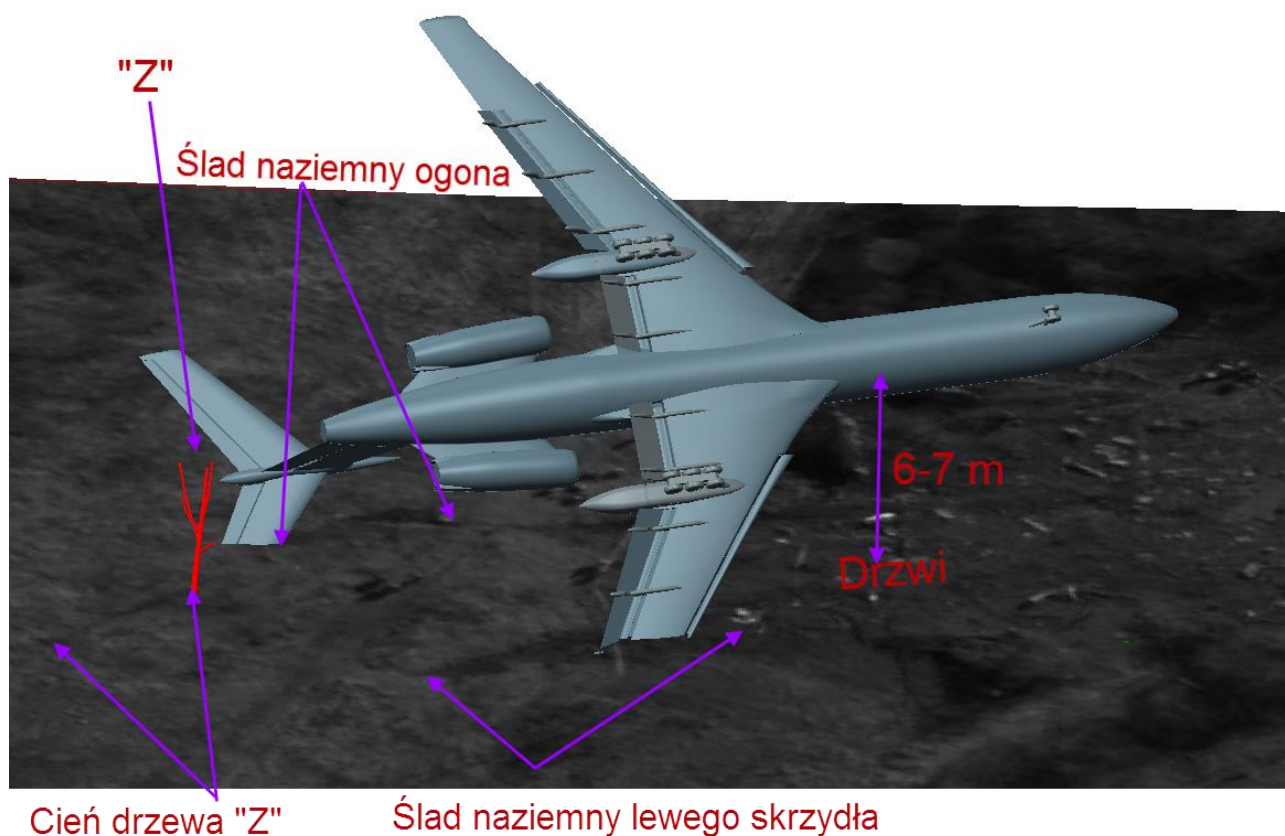
Rysunek 5. Nieuszkodzone drzewo o wysokości 6-7 m oznaczone literą "Z" znajduje się na bezpośredniej ścieżce lotu. Ślady naziemne zatrzymują się gwałtownie w miejscu, gdzie kadłub znajduje się nad pozycją, w której drzwi zostały wbite w ziemię.
