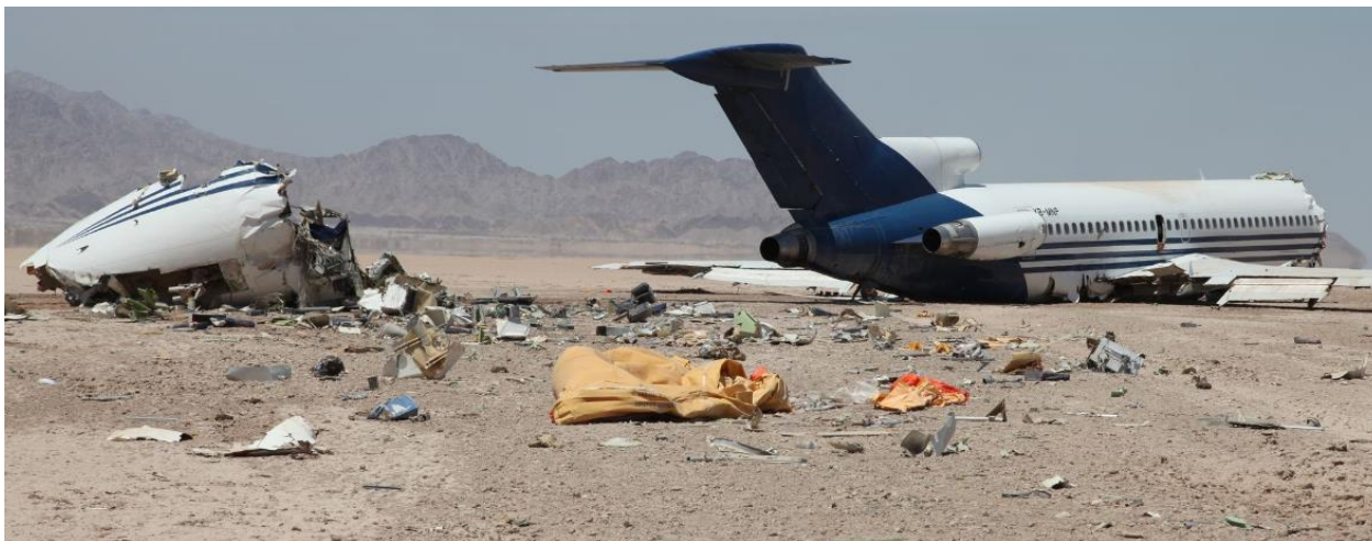
Rysunek 9. Przykład zniszczenia samolotu B727 podobnego typu, co TU-154M, uderzającego o twardy grunt z prędkością 225 km/godz. pod kątem nachylenia około 7 stopni . W Smoleńsku Tu154M uderzył o ziemię pod kątem 9 stopni.
