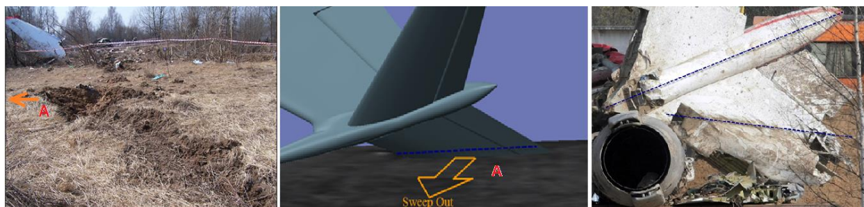
Rysunek 4. Zdjęcie po lewej stronie: Poludniowy ślad na ziemi dokonany przez ogon. Proszę zwrócić uwagę na przesunięcie boczne gleby w obszarze oznaczonym literą "A". Środkowe i prawe zdjęcie: Linia uszkodzenia lewego poziomego statecznika podczas nagłego skrętu w bok sekcji ogonowej.
