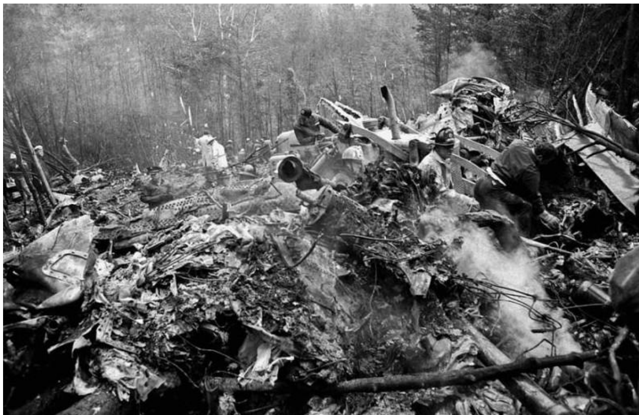
Rysunek 8. Przykład Czachora „na oddziaływanie siły 50G”. Niestety "zapomina" on poinformować, że większość szkód spowodowana została przez pożar po wypadku.
